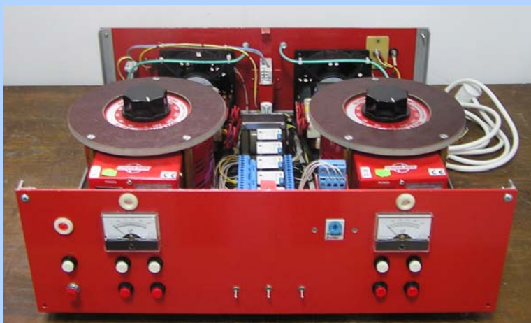
Unul din cele 3 module de alimentare si control pentru doua magnetroane, in diferite faze de executie
